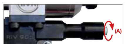
Girare il perno posteriore con chiave a brugola da 5 mm in senso orario per aumentare la pressione olio (forza) e in senso antiorario per ridurla.
