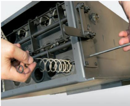
**Smontaggio facilitato delle aste per la pulizia dei tubi durante la manutenzione periodica.**
