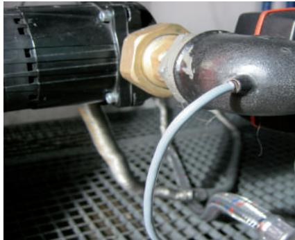
Sonda temperatura per i sistemi ausiliari di riscaldamento (puffer o accumulatori)
