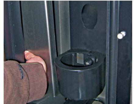
La camera di combustione è smontabile in 8 mosse per una facile pulizia del giro fumi. 1) estrazione frangi fiamma superiore, 2) estrazione paratia esterna di destra 3) estrazione paratia interna di destra
